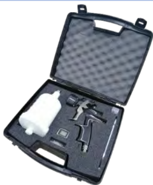
BLACK / S TMD1 AH141715 dostupne dizne 1.3 | radni pritisak: 2 ÷ 6 bara, Regulator pritiska i protoka vazduha | Digitalni manometar TMD1 (bar skala), PVC lonče 600ml sa filterom boje FV/S- 5000; 3/8M BSP navoj
